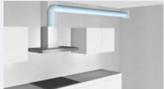
Beispiel einer guten Verrohrung
