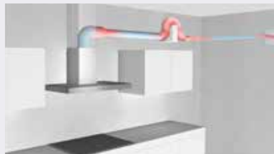
Beispiel einer schlechten Verrohrung
