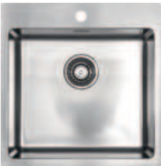
Ausschnittmaß Einbau: 480 x 485 mm Beckentiefe: 200 mm
