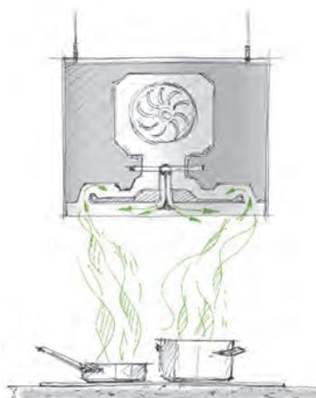
CenterFlow-Technologie: Für eine ausgesprochen ruhige und effektive Luftreinigung.
