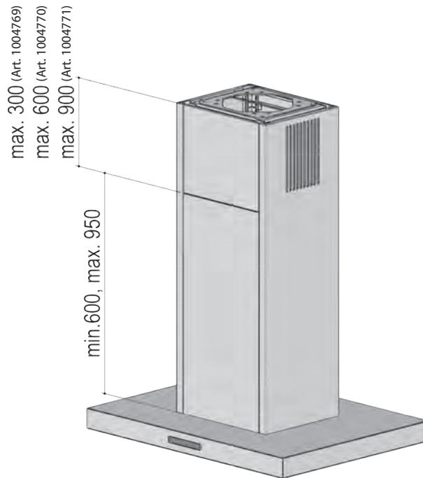
Mit der variabel anpassbaren Deckenkonsolle lassen sich die berbel Inselhauben Ergoline, Glassline und Blockline extrem einfach verlängern und unter abgehängten Decken befestigen. Die Konsolle kann so angepasst werden, dass sie den Leerraum zwischen tragender und abgehängter Decke genau ausgleicht. Das erleichtert die Montage, deckt Bautoleranzen des Deckenausschnitts ab und macht Sonderanfertigungen des oberen Kamins überflüssig.
