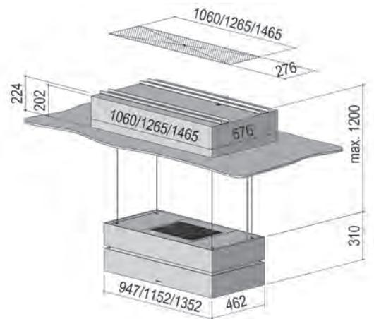
**DECKENANSCHLUSS mit Vollversenkbarkeit**
