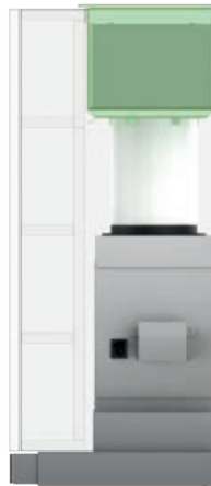
Einbausituation: scharnierte Türen Schrankschöhe: > 500 mm (max. 940 mm)
