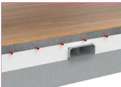
**Unter-Estrich-Verlegung:** COMPAIR STEEL flow® wird unter der Estrichschicht mit eingebauter Fußbodenheizung direkt in die Dämmschicht verlegt. Die Anforderungen an Schallschutz sind entsprechend den Nachweisen sicherzustellen.
